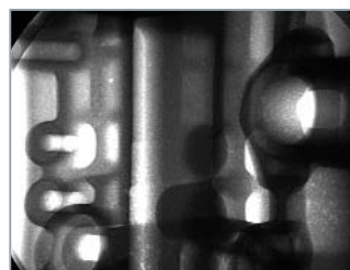
Корпус впрыскивающего насоса: 225 кВ; 3 мА
