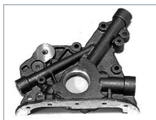
Корпус масляного насоса: 50 кВ; 7 мА
