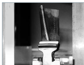
Турбинная лопатка: 60 кВ; 0,5 мА
