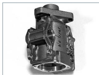
Корпус впрыскивающего насоса: 225 кВ; 3 мА
