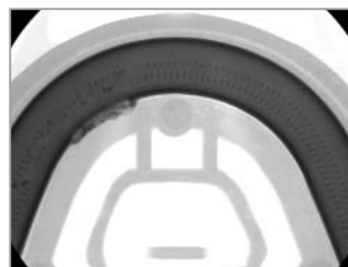
Корпус впрыскивающего насоса: 225 кВ; 3 мА
